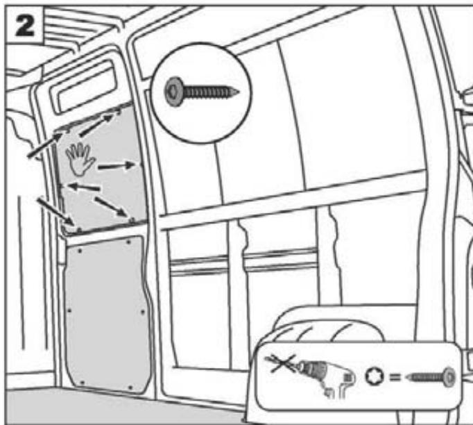
2 - Mettre **les capuchons en plastique** et fixer les parties basse et haute avec les vis **4,8 x 25**
